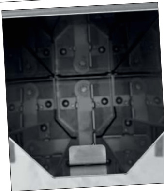
Werkzeuglose Schnellverstellung Dosierpaddel
