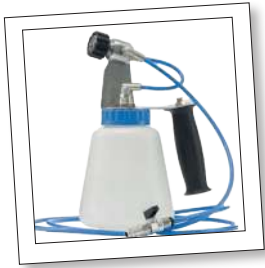
Desinfektions-Kalt-Nebelgerät HL-3D. Für Druckluftanschluss 3 bar, 180-220 l/min. Edelstahl/PVC
